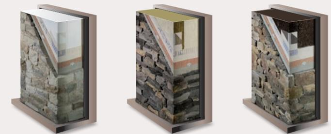
*Geopietra gewährleistet das Verlegungsverfahren von murogeopietra auf Wärmedämmung für den Außenbereich, geprüft nach ETAG 004 mit der Verwendung von Dämmplatten aus EPS, Mineralwolle und Kork.*
