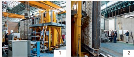
1. Einbau der Wand auf der Simulationsmaschine.
